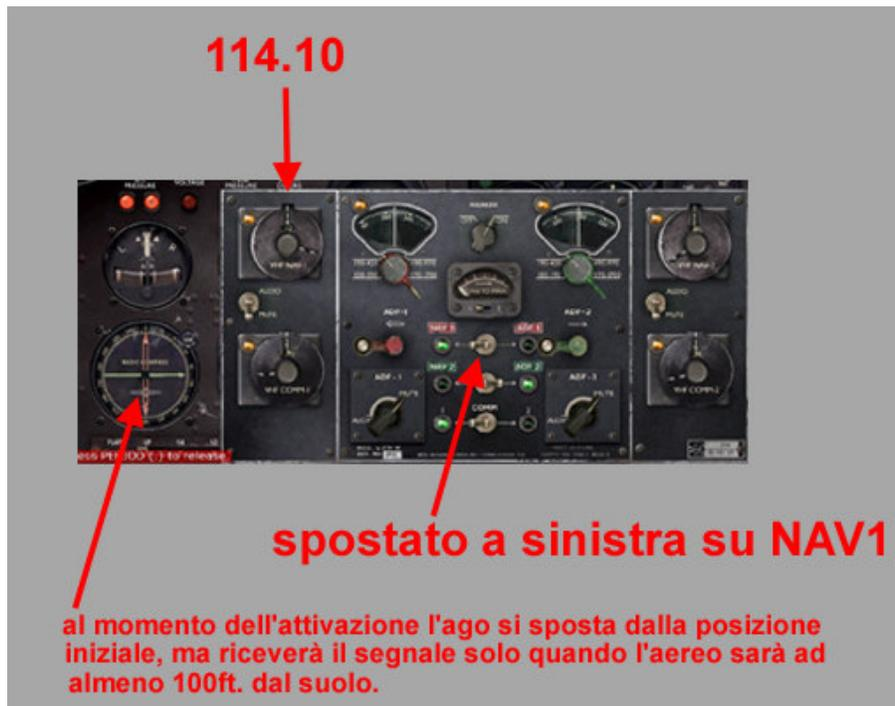
Una volta in volo e superata una quota minima, il ricevitore entrerà in funzione e il radio compass indicherà il **rilevamento polare** del radiofaro di Chioggia, nel nostro caso  $50^\circ$ . (N.B. bisogna abbandonare il concetto di radiale)
