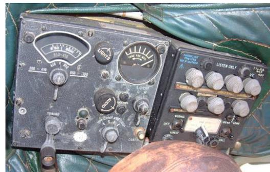
Per meglio comprendere il funzionamento e l'uso dello strumento facciamo un esempio pratico. Ci troviamo sull'aeroporto di Bologna LIPE e dobbiamo volare in direzione del radiofaro di Chioggia, frequenza 114.10. La pista è la 12, quindi al momento del decollo controlliamo che l'allineamento del girodirezionale corrisponda all'indicazione della bussola magnetica, altrimenti lo allineiamo ruotando la manopola apposita.
